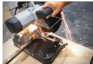
Pare-étincelles pour plus de sécurité Spark screen for safety use
