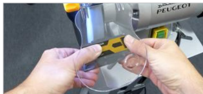
Dresseur incorporé pour rectifier les meules après affûtage Built-in dresser for grinding wheels for sharpening
