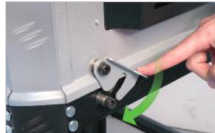
«Flash system» : séparation rapide «Flash system» : quick separation
