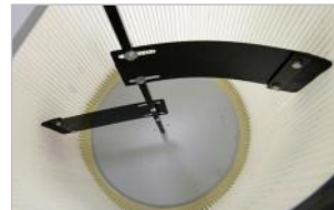
Décolmatage mécanique Mechanical unclogging
