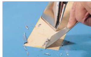
Décapage de peinture Paint stripping
