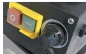
Variateur de vitesse (500-1700 tr/min) Speed variator (500-1700 tr/min)
