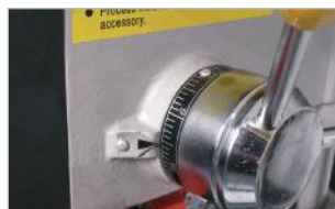
Butée de profondeur Depth gauge
