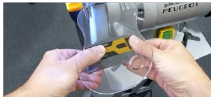
Dresseur incorporé pour rectifier les meules après affûtage Built-in dresser for grinding wheels for sharpening
