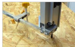
Guide de coupe circulaire Circular cutting guide
