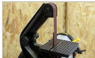
Changement rapide de bande Quick blade release
